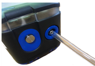
Figure 79 : Connecter le gaz d'étalonnage
