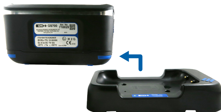
Figure 63 : détecteur en charge
