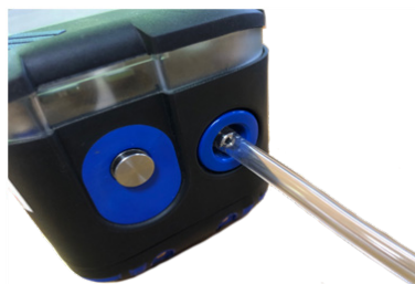
Figure 87 : Connecter le gaz d'étalonnage
