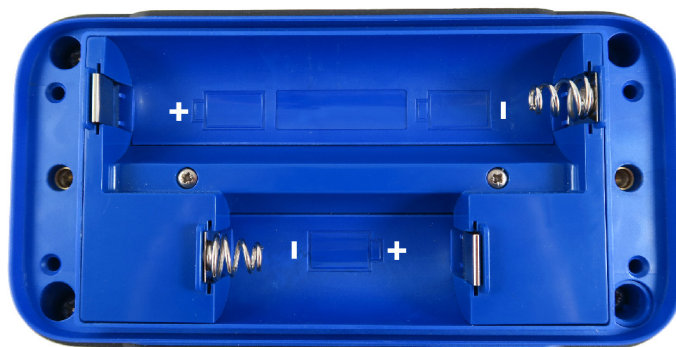
Figure 58 : compartiment des piles
