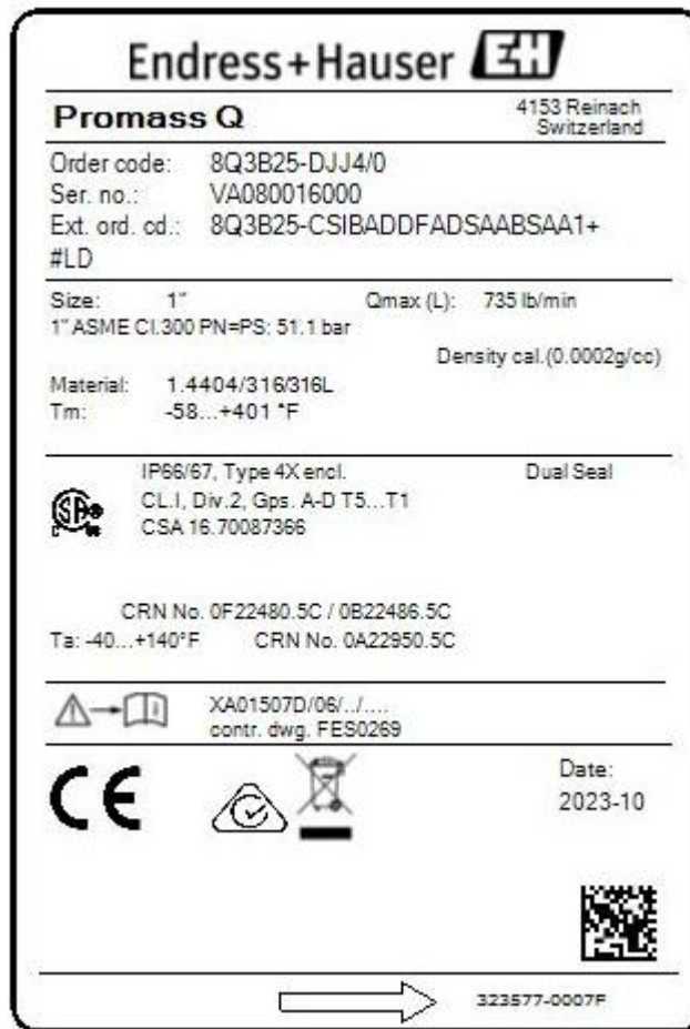
Figure 4: Additional nameplate for Promass Q300/ Plaque signalétique supplémentaire pour Promass Q300
